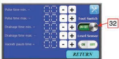
**Režim vypínač ON/OFF:** pri zapnutej odsávačke zatlačením na nožný ovládača zapneme odsávačku ako keby sme ju zaplnili hlavným vypínačom ON/OFF a opakovaným zatlačením odsávačku vypneme.
